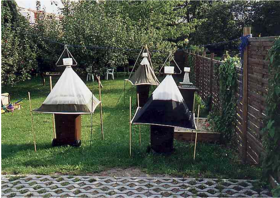
Abb. 1. Anordnung der Zeltfallen über den Biotonnen zur Erfassung des Fliegenanfluges
