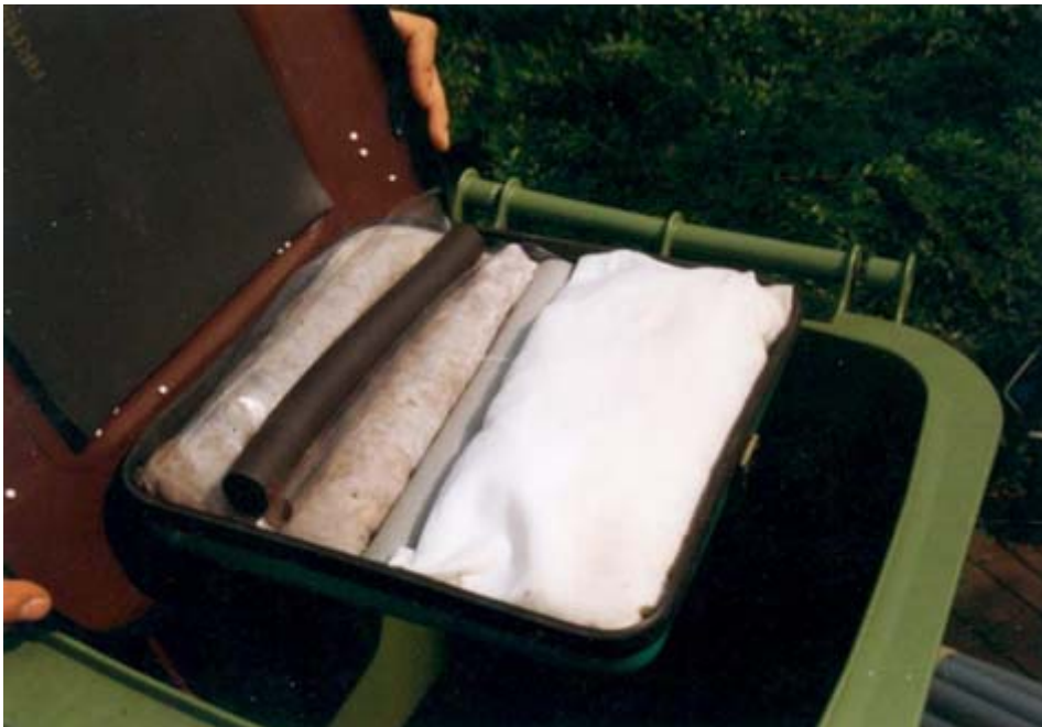
Foto 3: Deckel mit Biofilter( Modell I), Filter von innen
