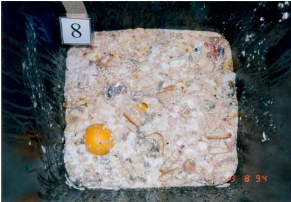
Foto 18: Außenversuch Biologic, Biotonne mit Biofilter, 7 Tage nach der Befüllung
