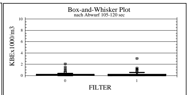
Abb. 140: Pilzsporenemission nach dem Abwurf von Biomüll in Tonnen ohne (0) und mit (1) Filter,
