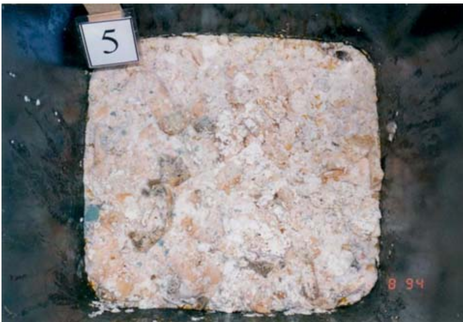
Foto 19: Außenversuch Biologic, Biotonne mit Biofilter, 10 Tage nach der Befüllung
