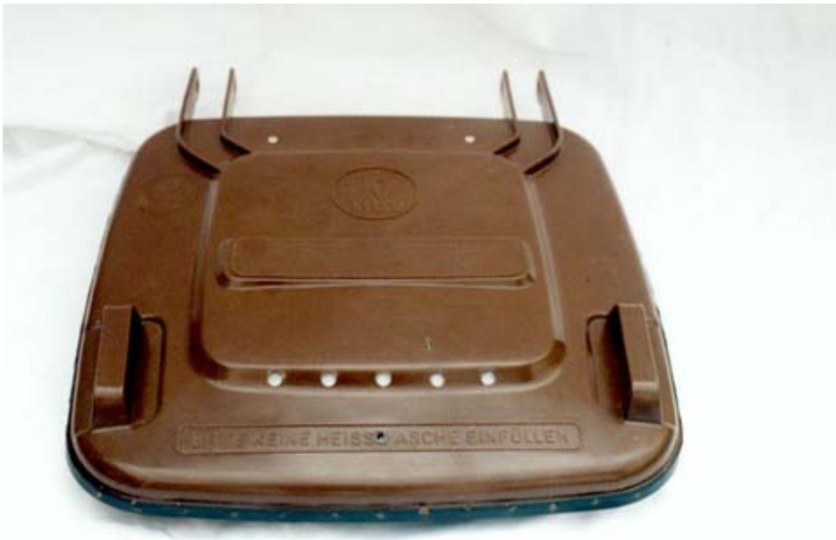
Foto 1: Deckel mit Biofilter (Modell I) und umlaufender Dichtung (Aufsicht)
