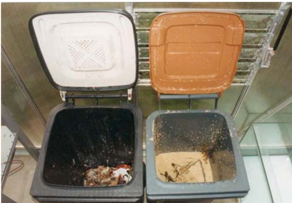
Foto 21: Außenversuch Biologic, identisch befüllte Biotonnen 12 Tage nach Erstbefüllung. Links mit Biofilter (Vorserienmodell), rechts herkömmliche Biotonne mit seitlichen Belüftungsöffnungen am Deckel.
