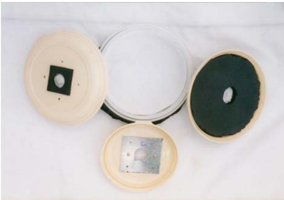
Foto 6: Deckel mit Biofilter (Modell II), Gehäuseteile ohne Füllung
