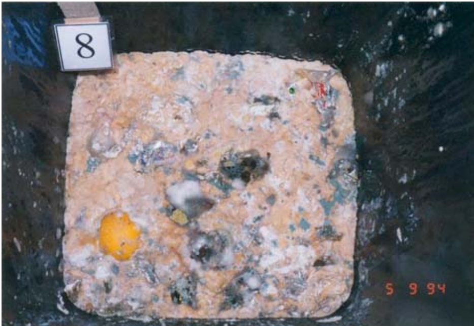
Foto 20: Außenversuch Biologic, Biotonne mit Biofilter, 19 Tage nach der Befüllung
