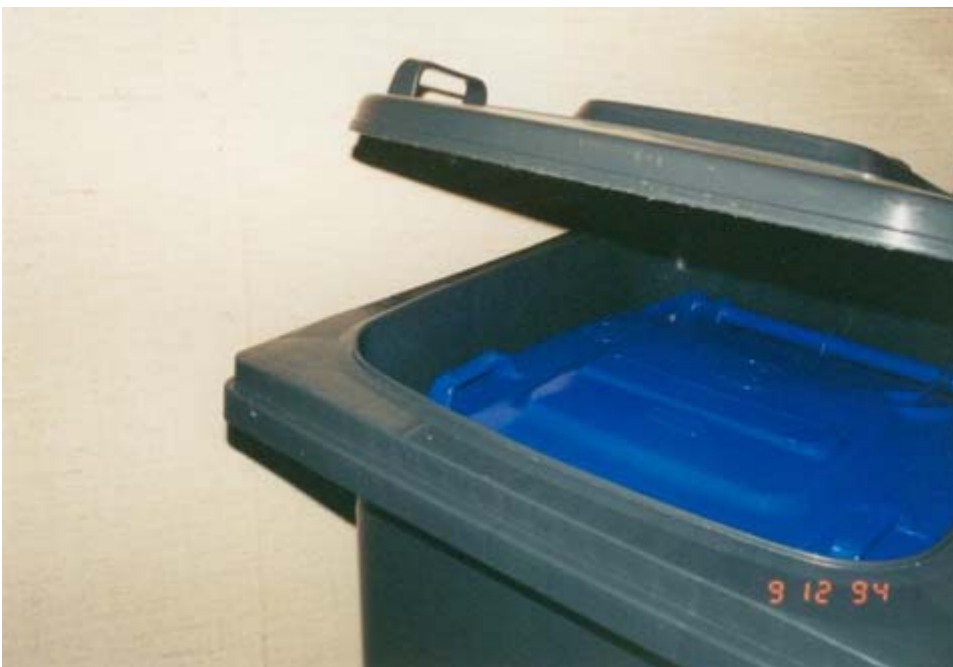
Foto 10: Umtonnenversuch, Biotonne in Umtonne zur standardisierten Erfassung von Emissionen
